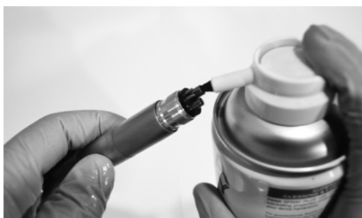
Iniezione di olio di manutenzione nel canale spray (olio di manutenzione art. n. 174010 e adattatore canale spray art. n. 17401150)
